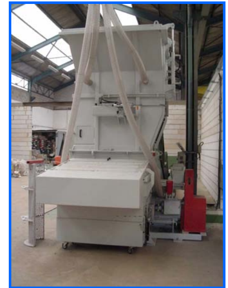
Tolva especial con tapa y aspiración neumática para el polvo
